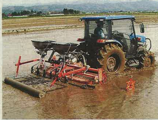
代かきや種まきなどが同時に行える農業機械の試作品（石井製作所提供）
