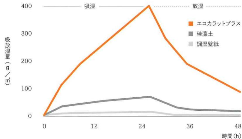
※ 試験結果は当社試験(相対湿度50%→90%→50%にした時の吸湿/放湿量を測定)によるものです。部屋の使用条件、気象・換気などの環境条件によって異なります。
