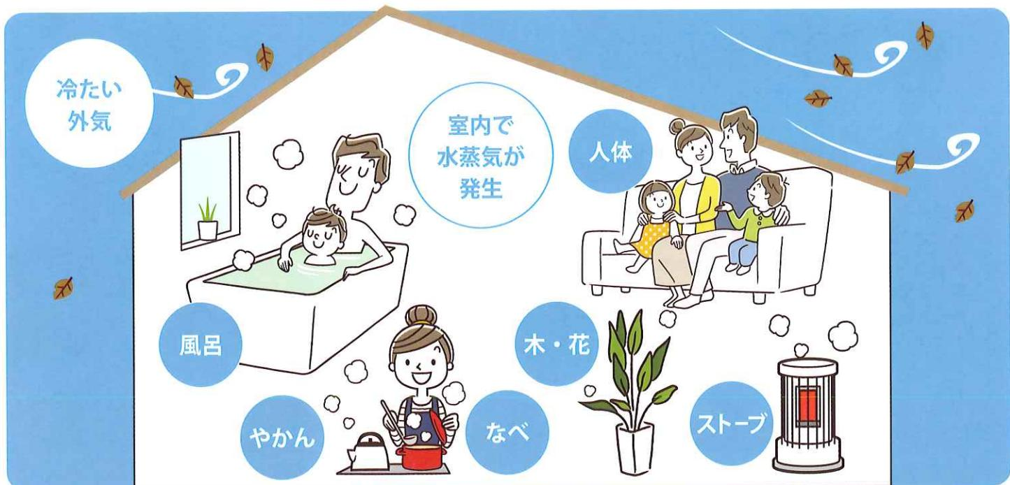
寒くなると窓に「結露」が発生してしまうことはないですか？結露は、窓枠やガラスを水滴でよごすだけでなく、カビやダニの発生、アレルギーの要因になるなど、さまざまな健康被害を引き起こす可能性があります。①室内で水蒸気が発生する、②冷たい外気が窓の表面温度を下げる、③水蒸気を含んだ室内の空気が窓に触れる、これが結露発生のプロセスです。結露について、抑制するポイントを知っておきましょう。
