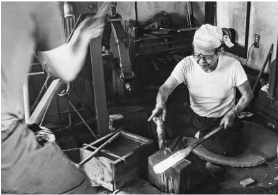
④熱した玉鋼を鍛錬し、指揮棒の形に整える
