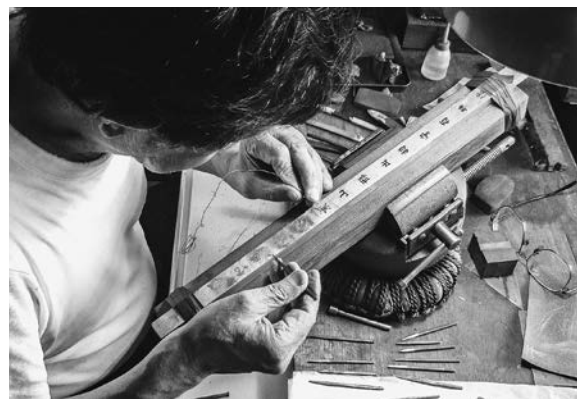
⑤指揮棒の形に形成したものの表面に文字を彫り、金を埋め込む(金象嵌)作業
