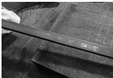
⑦錆びつけ用の溶液を塗布して黒錆を発生させる作業
