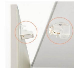
揺れを感知すると、ストッパーが下りて扉をロック。収納物の落下や飛び出しを防ぐ安心機能です。揺れが収まると自動的にロックを解除します。
