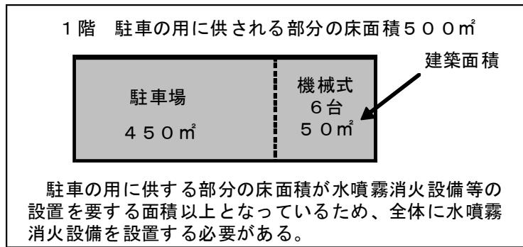
イ 機械式駐車場部分を含めた駐車の用に供される部分の床面積が令第13条第1項第5欄に規定する床面積未満で、機械式駐車場の収容台数が10以上の場合は、当該機械式駐車場部分のみ水噴霧消火設備等を設置するものとする。
